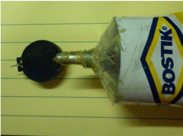
mettiamo una goccia di colla per fermare il portabatteria al c.s.
