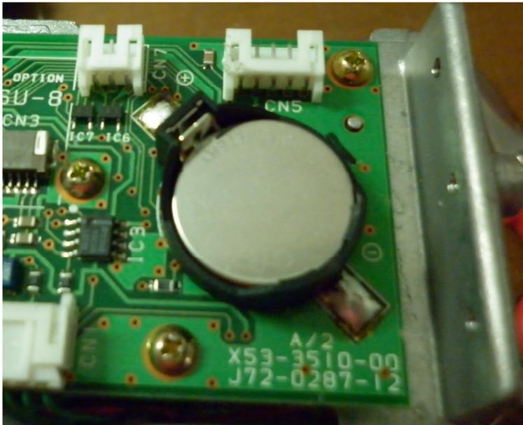
mettiamo la batteria una CR2032, e richiudiamo l'apparato, riprogrammiamo le nostre memorie, lavoro finito.
